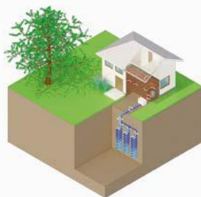
Pompe à chaleur sur corbeilles géothermiques
