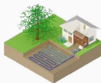
Pompe à chaleur sur capteurs enterrés horizontaux
